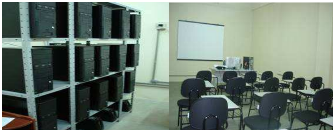
Figura 12: Cluster PLANCK, formado por com 23 computadores com processadores Core2Quad, para processamento em paralelo de alto desempenho.
